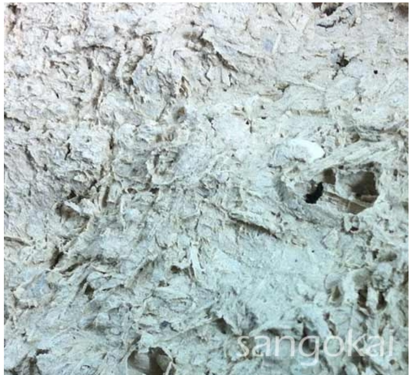
Foto 5: Die Oberfläche der Riffsystem Keramik ist sehr stark strukturiert, wodurch die Siedlungsfläche sehr hoch ist. Foto: Jörg Kokott
