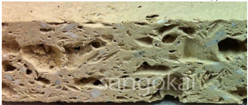
Foto 3: Die Porosität der Riffsystem Keramik spielt auch als Substrat für Bakterien und Mikroben eine wichtige Rolle. Dadurch kann eine vielfältige Artenvielfalt entstehen. Damit sind die Anforderungen des SANGOKAI Systems an die Keramik erfüllt. Foto: Jörg Kokott.
