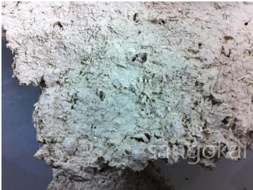
Foto 4: Die Struktur der Riffsystem Keramik hat Ähnlichkeit mit der von porösem Riffgestein. Die horizontale Ausfertigung der Plateaus bietet viel Stellfläche, und die offene Bauweise ermöglicht eine Ansiedlung z.B. von Schwämmen auf der Unterseite. Foto: Jörg Kokott
